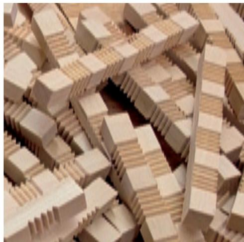
**Seitlich wechseln** Die keilförmigen Vertiefungen werden an drei Seiten eingebracht. Hierfür muss das Vierkantholz zweimal in der Trommel gedreht werden.
