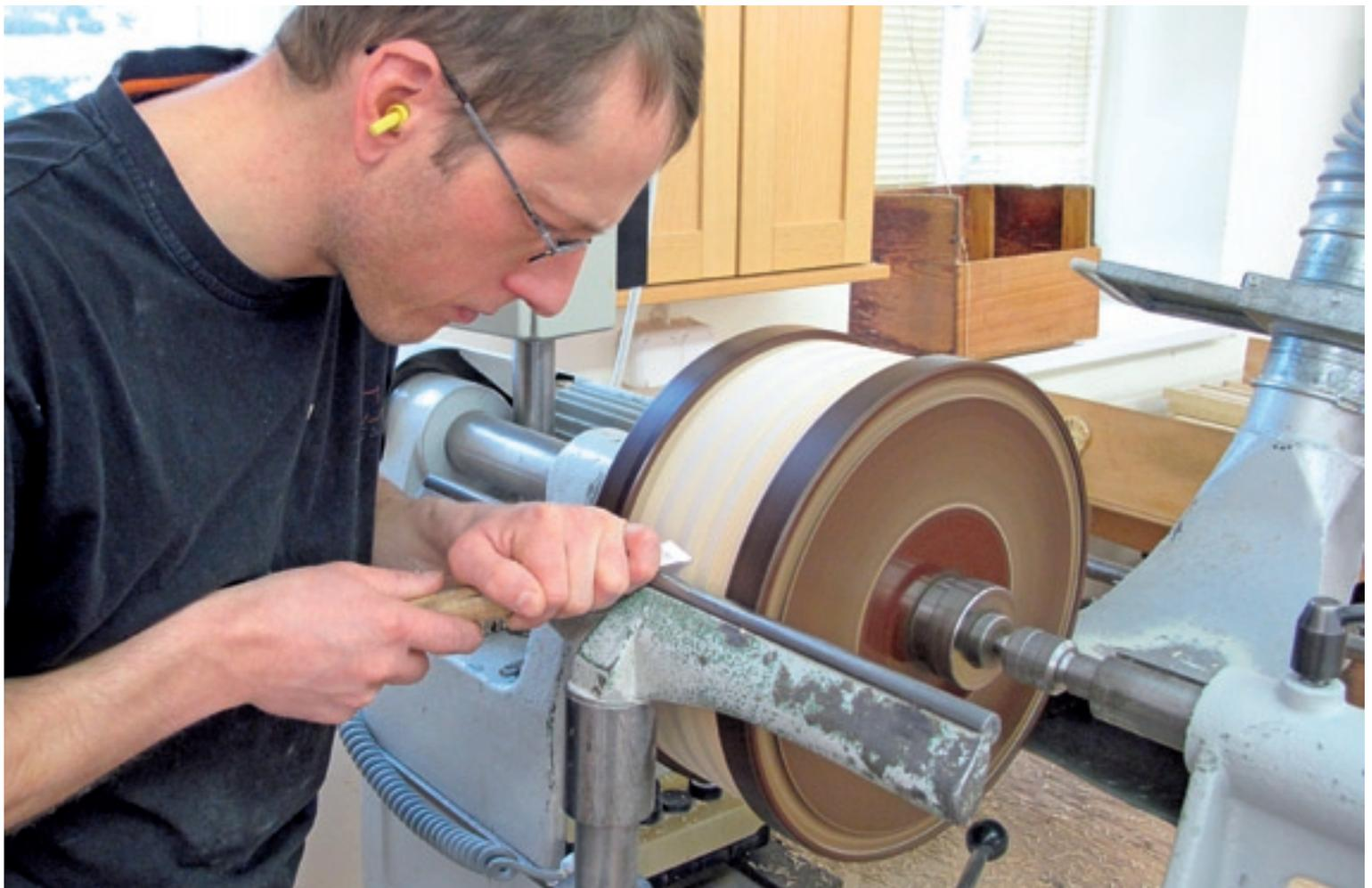
**Kantig drehen** Die in einer Trommel eingespannten Kanthölzer – pro Trommel sind das 86 Stück – erhalten während des Drehens mit dem Drechseisen jene typischen Einkerbungen, die dem Blasebalg der späteren Ziehharmonika sein charakteristisches Aussehen verleihen.
